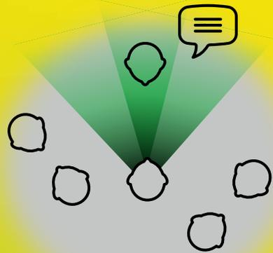
Combina a direccionalidade independente tradicional com o processamento omnidireccional. Desempenho limitado em ruído.
